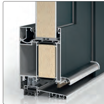
Aluminium-Haustür PaXentree | Bautiefe 87 mm | thermisch getrennt
